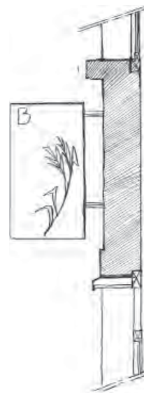
Enseignes en drapeau positionnées sous l'appui de la baie du premier étage (1)
