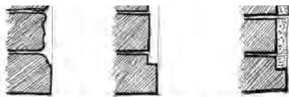
Remplacement par un mortier de reconstitution après affouillement (si la profondeur est inférieure ou égale à 2 cm)
