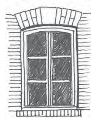
Le châssis doit épouser la forme de la baie. Ici il s'adapte au centre de la baie
