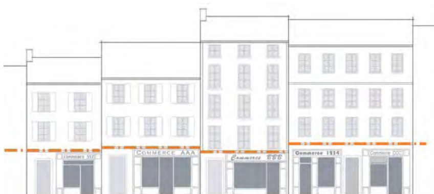
Les lignes horizontales des rez-de-chaussée marquent la limite du socle de la façade.
